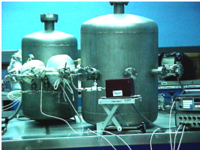
Figura 3. Sistema de referencia nacional para la medición de vacío.
